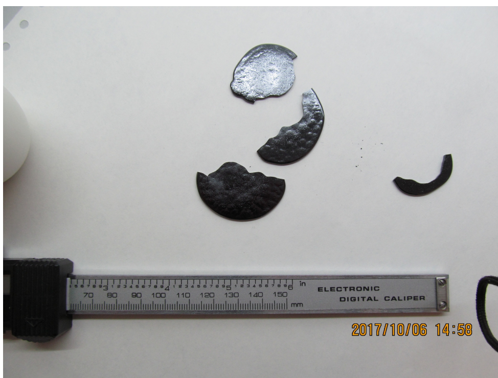
Rys. 16. Próbki wytworzone tradycyjną metodą wytopu.
