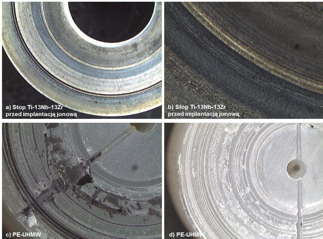
Rys. 111. (LM) Widok powierzchni badanych próbek pary trącej nieimplantowany stop Ti-13Nb-13Zr / PE-UHMW po testach tribologicznych: a, b) nieimplantowany stop Ti-13Nb-13Zr, c, d) PE-UHMW
