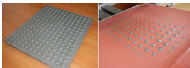
Rys. 1. Eksperymentalna nawierzchnia składająca się z regularnych sferycznych wybrzuszeń o wysokości XXX. mm. Z lewej strony widoczna pełna tekstura, a z prawej strony tylko ta jej część, która ma kontakt z gumą bieżnika (szary kolor)
