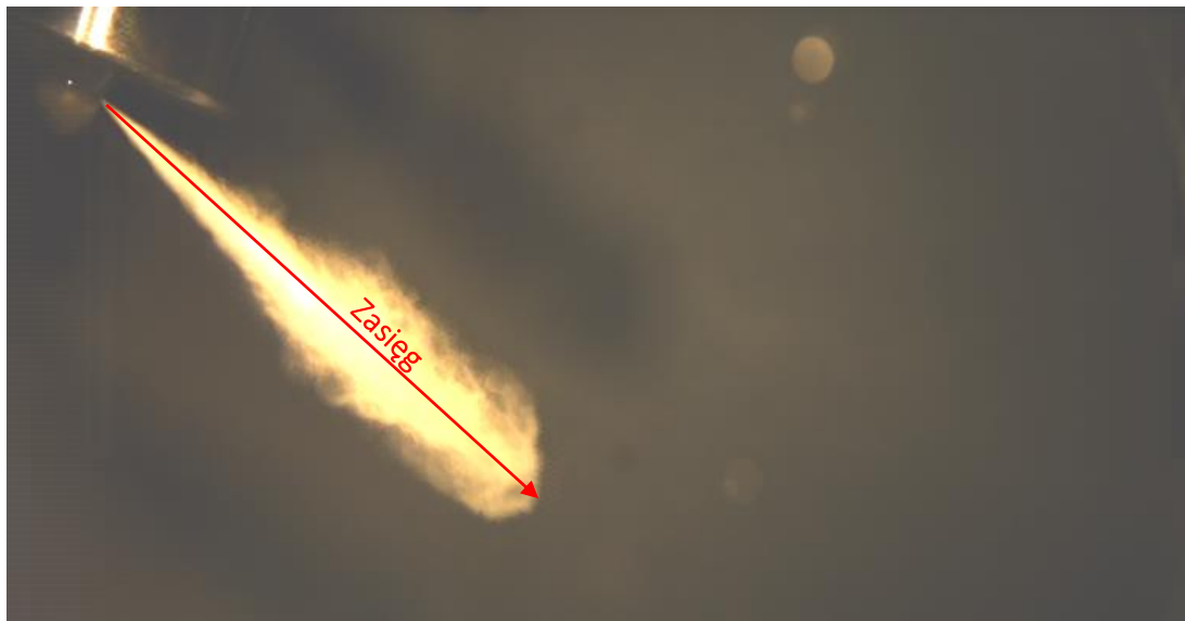
Rys. 5.10 Definicja zasięgu strugi rozpylanego oleju napędowego w ramach analizy głównych badań eksperymentalnych: a. 3,62 ms, b. 4,29 ms, c. 4,96 ms
