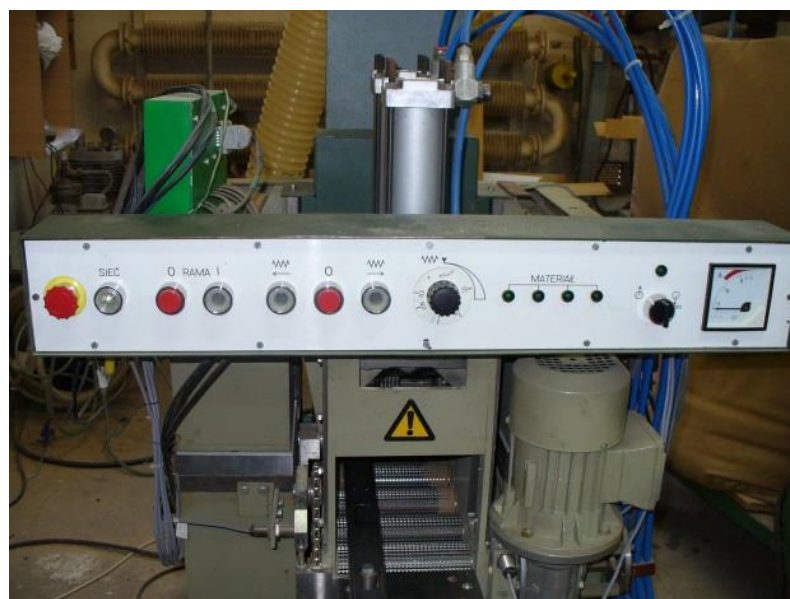
Rys. 7.10. Pilarka ramowa PRW 15M: a) widok wałców dolnych (napędzających) i górnych (dociskających) od strony wejścia materiału obrabianego, b) panel sterowania (zdjęcia własne)
