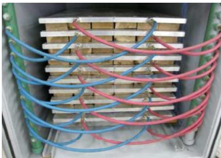
Rys. 3.5. Sposób ułożenia drewna w suszarni próżniowej z ogrzewaniem kontaktowym (Maciąg 2009)
