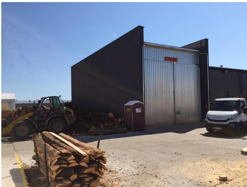
Rys. 7.6. Suszarnia O.S. Panto typu OS 120/F w PHU Drew - Met (zdjęcie własne)
