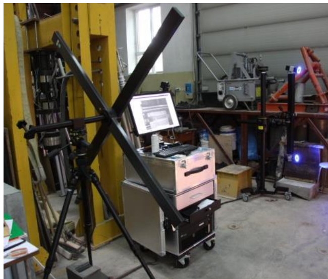
Rys. 4.25 Widok wzorca kalibracyjnego oraz głowicy pomiarowej 3D (układ dwóch kamer)
