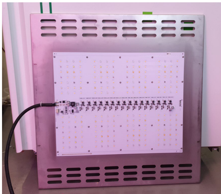
Rys. 16. 16-kanalowy programowalny moduł LED.
