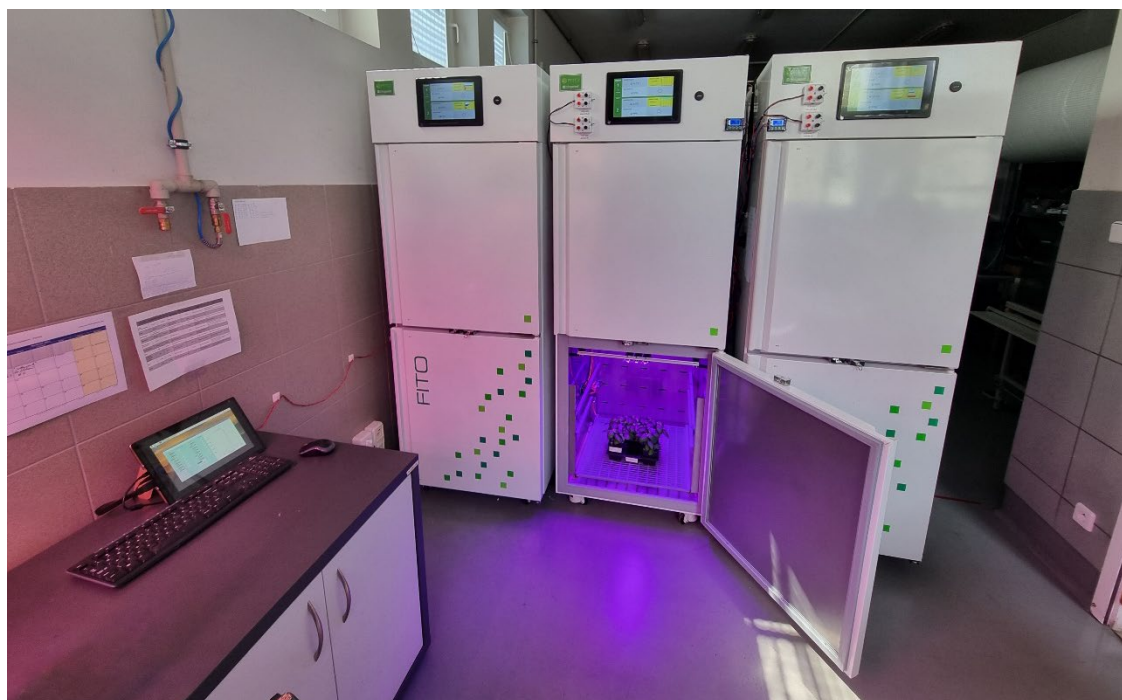
Rys. 15. Widok stanowiska badawczego opartego na szafach fitotronowych.
