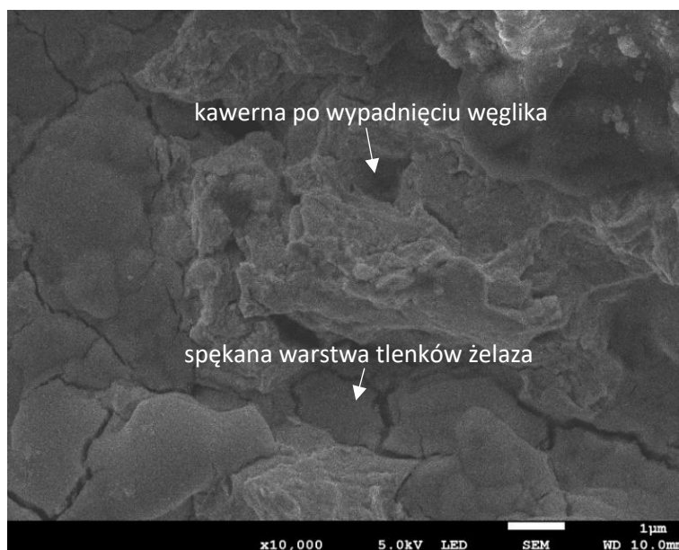
Rys. 97. Spękana warstwa tlenków żelaza na odkształconej plastycznie powierzchni stali P110 uwidocznioma po 370 min testu kawitacyjnego w wodzie destylowanej o temperaturze 25 °C.
