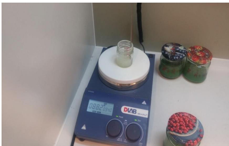
rys. 10.1. Mieszadło magnetyczne wykorzystywane do mieszania rozpuszczalnika i nanocząstek z żywicą.
