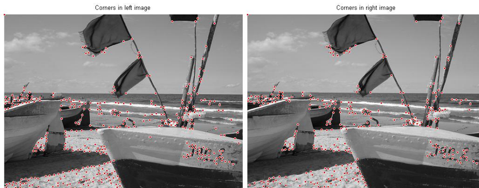
Rys. 2. Obraz lewy i prawy środowiska testowego z oznaczonymi narożnikami wykrytymi metodą Harissa (źródło: opracowanie własne)
