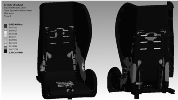
Rys. 7. Wyniki analizy: odkształcenia zredukowane, widok aksonometryczny z przodu i z tyłu (skala odkształceń 1:1) [1]
