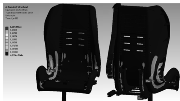
Rys. 16. Wyniki analizy: odkształcenia zredukowane, widok aksonometryczny z przodu i z tyłu (skala odkształceń 1:1) [1]
