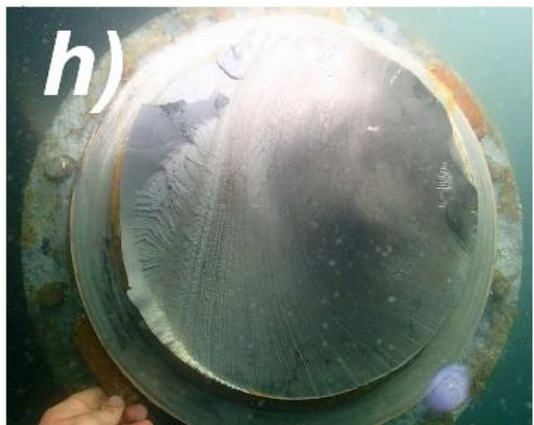
Rys. 1. Uszkodzenia zmęczeniowe wałów napędowych statków:
