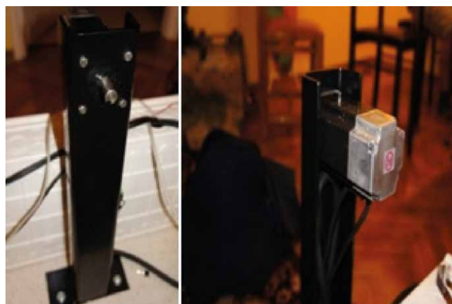
Rys. 3. Serwomotor zamontowany na ceowniku
