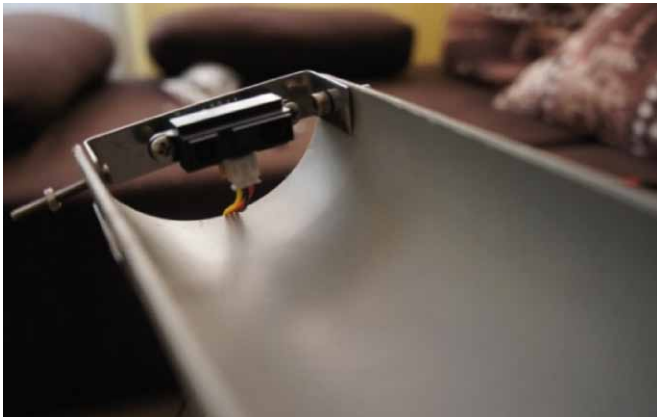
Rys. 5. Odbiciowe urządzenie pomiarowe zamontowane na równi pochyłej
