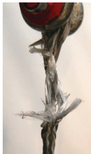
Rys. 11. Próbką po zerwaniu
