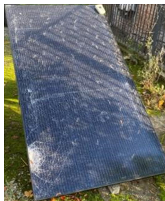
Rys.4. Uszkodzona powierzchnia modułu PV o danych znamionowych zawartych w tabeli 3
