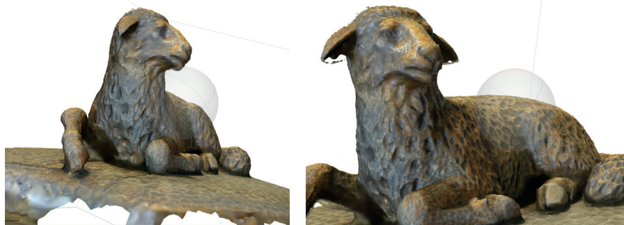
Rys. 8. Brak ostrości detali, rozmycia i niedokładności w teksturze oraz zmniejszona precyzja w odwzorowaniu powierzchni obiektu będące następstwem użycia fotografii o niedostatecznej ostrości
