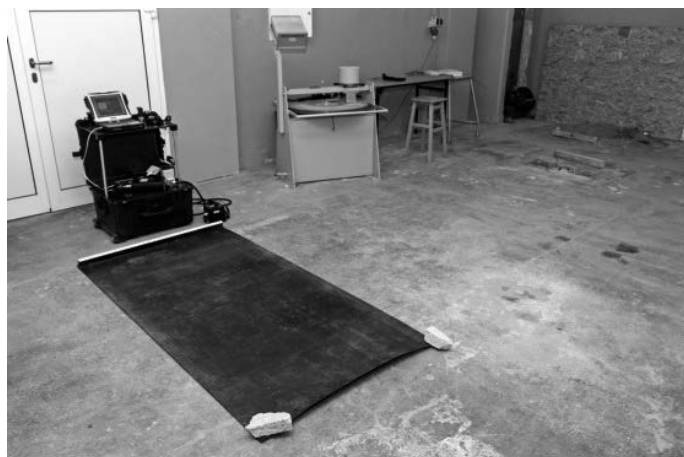
Rys. 3. Badanie konstrukcji podłogi w pomieszczeniu laboratoryjnym (sala nr 10, budynek Żelbet, Katedra Budownictwa i Inżynierii Materiałowej, Politechnika Gdańska) za pomocą metody georadarowej z użyciem maty PSG
