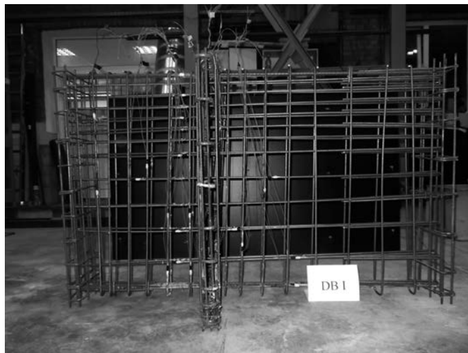
Rys. 3. Zbrojenie tarczy DB-I (zbrojonej ortogonalnie)
