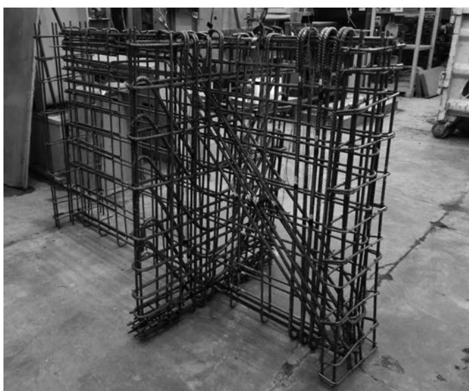
Rys. 4. Zbrojenie tarczy DB-II (z dodatkowym zbrojeniem ukośnym)
