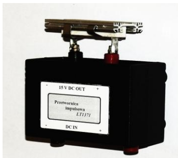
Rys. 7. Zdjęcie zrealizowanego układu na przetwornicy LT1371
