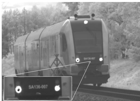
Rys. 15. Obraz pojazdu szynowego zarejestrowany w paśmie podczerwieni kamerą NIR wraz z powiększonym fragmentem zawierającym jego serię i numer
