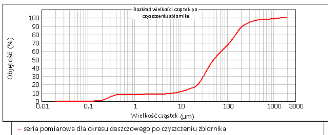
Rys. 4.25. Rozkład wielkości cząstek zawiesiny w odpływie z systemu hydrofitowego dla okresu deszczowego po czyszczeniu zbiornika sedymentacyjno-retencyjnego ( n = 10 )
